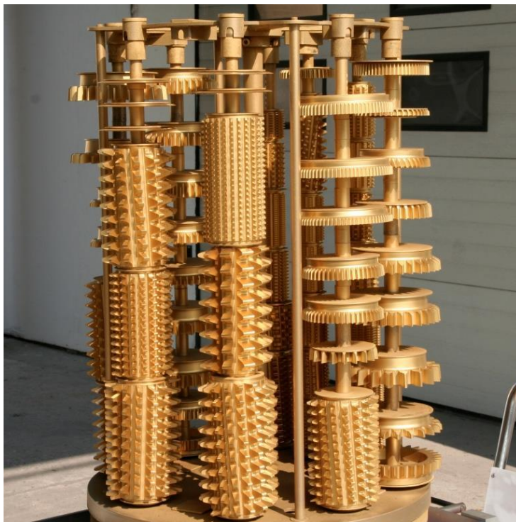
Figura N°06.1 - Carica di utensili per il taglio di ingranaggi cilindrici all'uscita dell'impianto di ricoprimento
